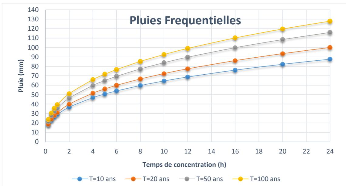
Figure 4.3. Pluies fréquentielles de la station de MEHALMA
